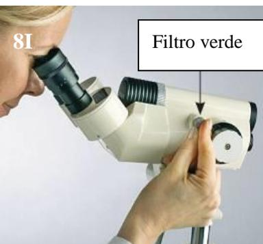
Nota: Sia il pomello reostato nero sia quello del filtro verde argentato sono comodamente posizionati sulla testa del colposcopio. In questa maniera l'utente ha un controllo totale dello strumento senza sollevare gli occhi dagli oculari.
