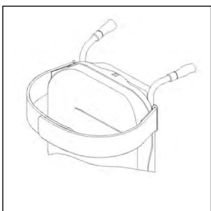
A protezione durante la funzione verticalizzante e di sollevamento la sedia è dotata di cinghia toracica sullo schienale superiore. Sovrapporre i singoli passanti della cinghia toracica e premerli saldamente gli uni sugli altri. La cinghia toracica è fissata da un sistema di chiusura con velcro.
