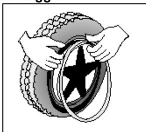
Spingere la protezione della camera d'aria sopra alla valvola di quest'ultima ed inserirla nel cerchione. A questo punto la protezione della camera d'aria può essere facilmente montata. Verificare che tutte le teste dei raggi siano coperte (se si utilizzano cerchi in plastica non si utilizza la protezione della camera d'aria).
