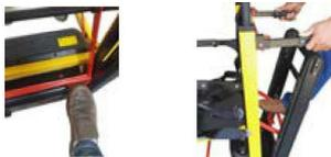
**Apertura:** Posizionare un piede sul pedale; il cingolo si aprirà automaticamente grazie al sistema di sollevamento a gas.
