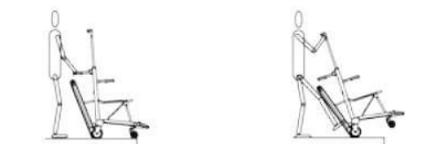
1. Posizionare la sedia portantina per scale sul suolo fino a posizionare le ruote anteriori sul bordo della scala.
