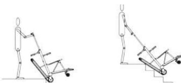
3. Posizionare lentamente la sedia portantina sul primo bordo per la discesa, quindi adattare lentamente lungo il senso della scala.
