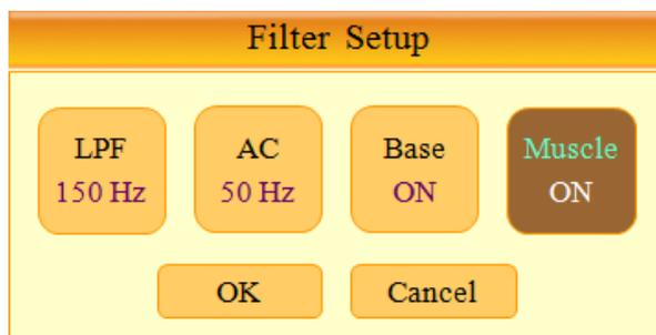
L'utilizzo dei filtri può distorcere i segnali originali. È quindi raccomandabile di non abusare dei filtri se non necessario. Di default solo i filtri AC e della linea di base sono impostati su ON. L'uso del filtro elettromiogramma dipende dalle condizioni del segnale. Quando il segnale in uscita è molto disturbato, è consigliato impostare il filtro LPF a 40Hz.
