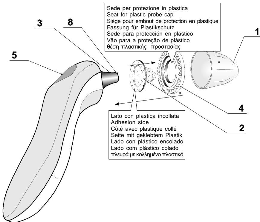
N.B. = La plastica alla base della protezione monouso (2) sarà rivolta verso l'apparecchio, e l'anello applicatore (4) avrà la sede per il contenimento della protezione verso di essa.
