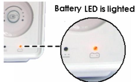
3. Le batterie vengono automaticamente ricaricate quando si collega la macchina alla presa di corrente. L'apposito LED lampeggia e poi rimane acceso.
